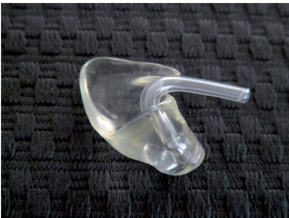
Fot. 3. Wkładka pełna, standardowy dźwiękówód (wężyk silikonowy o wymiarach 2.0 x 3.0 mm), trzpień przycięty na drugim zakręcie, wentylacja Y (otwór wentylacyjny na wysokości pierwszego zakrętu wchodzi w dźwiękówód) (średnica wentylacji 1.4 mm)
