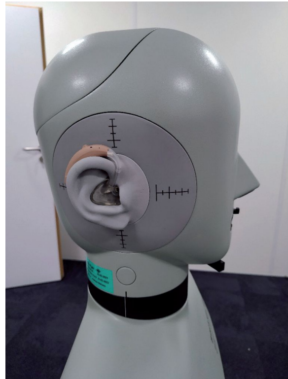
Fot. 9. Układ pomiarowy wykorzystany w pomiarach akustycznych (High-frequency Head and Torso Simulator Brüel&Kjær Type 5128)
