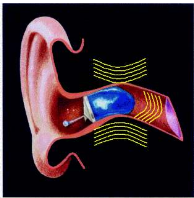
Rys. 1. Efekt okluzji wywołany zamknięciem przewodu słuchowego zewnętrznego aparatem słuchowym (źródło: J.Growth, C.T.Jespersen, L.Christensen, How open fittings can open doors )
