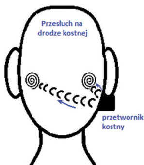
Rys. 4. Schemat przesłuchu międzysznego jaki może powstać podczas badania progu przewodnictwa kostnego [4]
