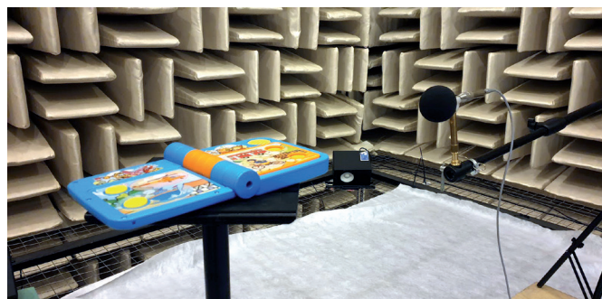
Rys. 1. Pomiar zabawki typu floor/table-top toy zgodny z normą [15]. Miernik poziomu dźwięku w odległości 50 cm od zabawki
